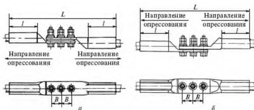
Рис. 1.40. Соединительные петлевые переходные зажимы типа ПАС (а) для соединения проводов в шлейфе анкерной опоры и типа ПП (б) для перехода с одной марки провода на другую в шлейфах анкерных опор
